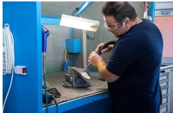
Giuseppe Ballarino arbeitet in der Endbearbeitung bei GF Precicast. Dort werden die Gussteile entgratet oder poliert.
