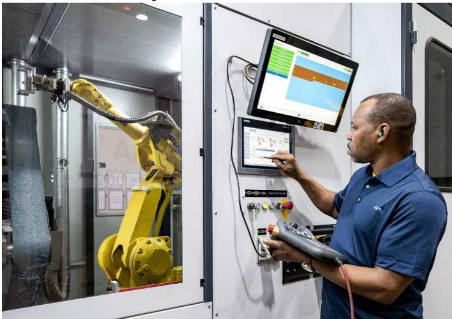
Die neue Schleifzelle ist ein geschlossener, schallisolierter Raum. Die Maschine schleift vollautomatisch mit drei digital gesteuerten Robotern und verputzt die Gussteile palettenweise ohne Lärm- und Staubemissionen.
