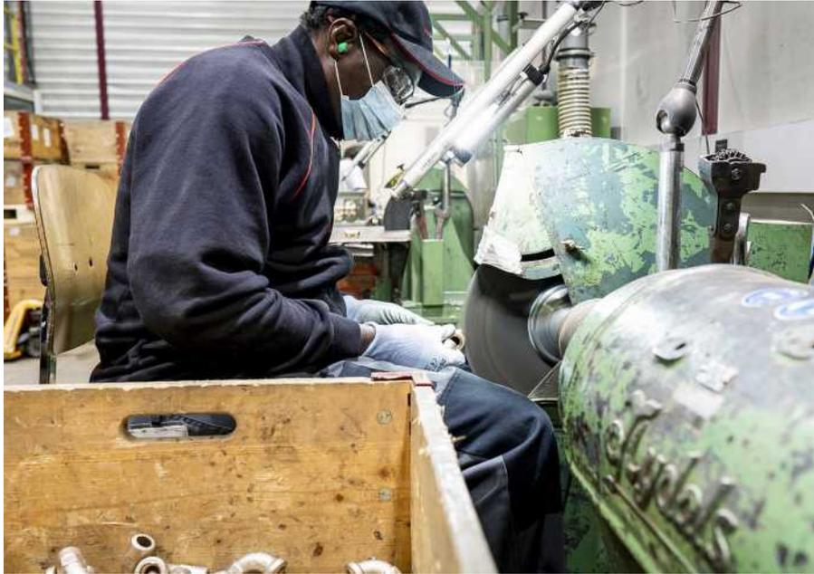
Das Wegschleifen von scharfen Formtrenngraten ist eine monotone und körperlich belastende Arbeit, die ständige Konzentration erfordert.
