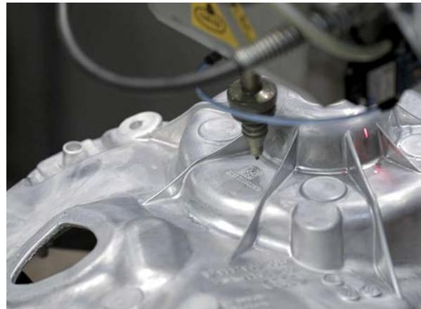
Ein eindeutiger QR-Code, der per Lasermarkierung auf Komponenten von GF Casting Solutions angebracht wird, ermöglicht die Rezyklierung dieser Komponenten.
