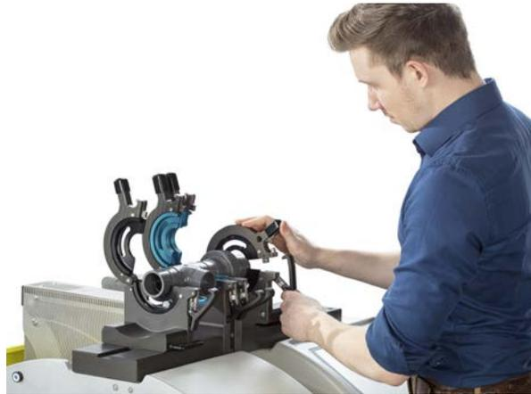
Das neu eingeführte IR PVC U System kommt ohne Lösemittel aus und verbessert die Arbeitssicherheit, da gefährliche Dämpfe vermieden werden.
