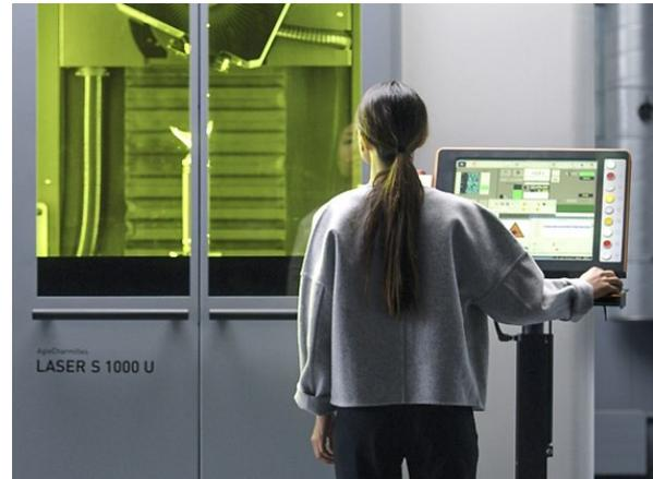
Das Lasertexturierungsverfahren von GF Machining Solutions stellt eine sauberere und schnellere Alternative zum chemischen Ätzen dar.
