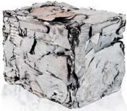
Ein Schrottwürfel hat eine Kantenlänge von 50 cm und ein Gewicht von 200 kg. Bis zu 4 000 Schrottpakete werden Tag für Tag in der Giesserei weiterverarbeitet, sie enthalten viele wertvolle Rohstoffe.
