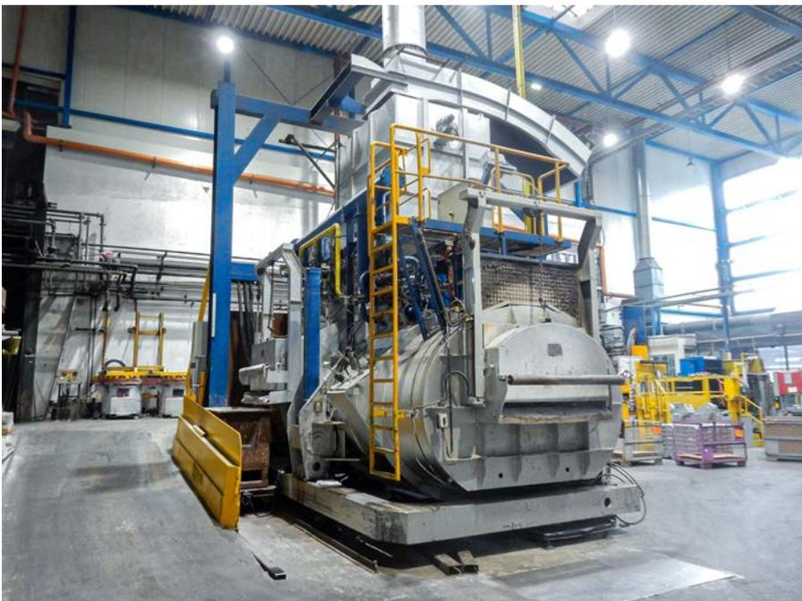
Schmelzofen für Aluminium mit installiertem Abluftmodul am Standort von GF Casting Systems in Altenmarkt (Österreich).
